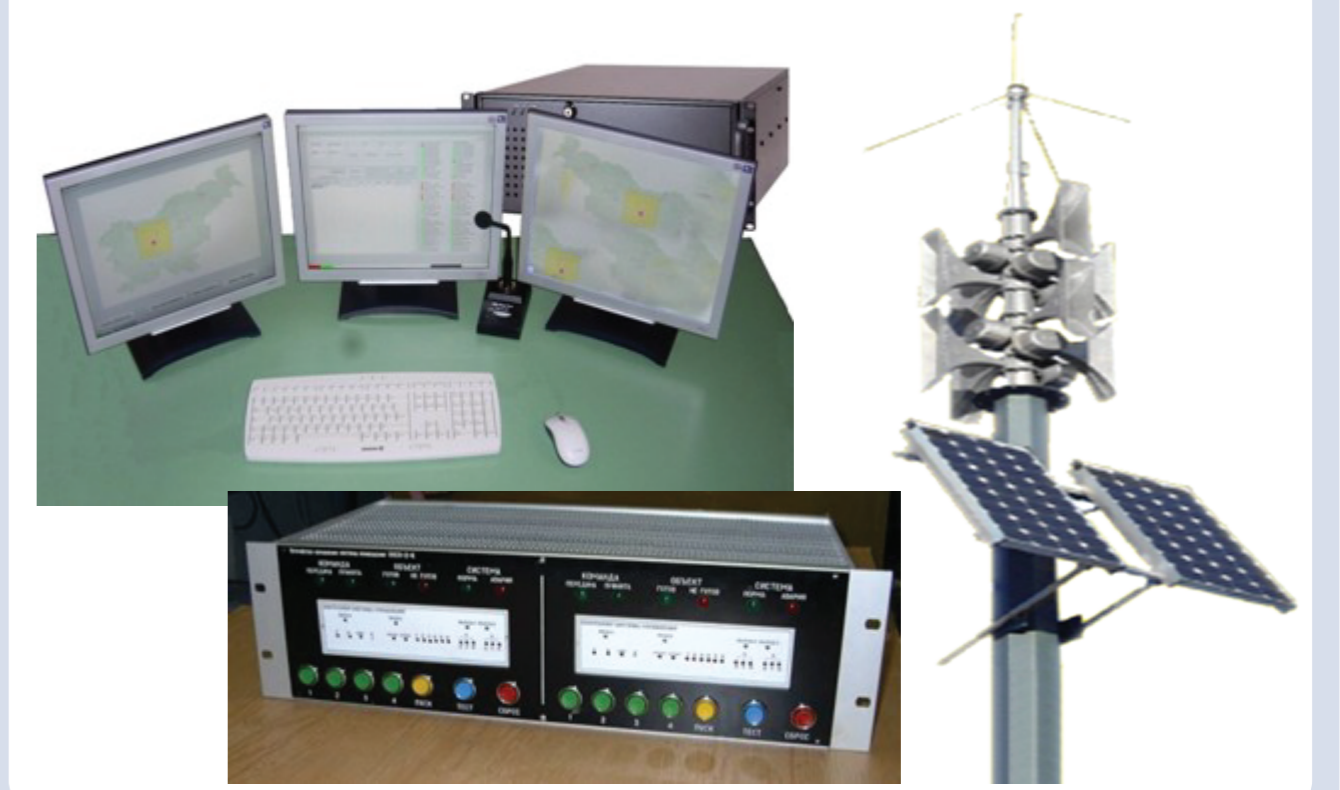
Комплекс программно-аппаратных средств системы оповещения КПАСО «МАРС-АРСЕНАЛ»
